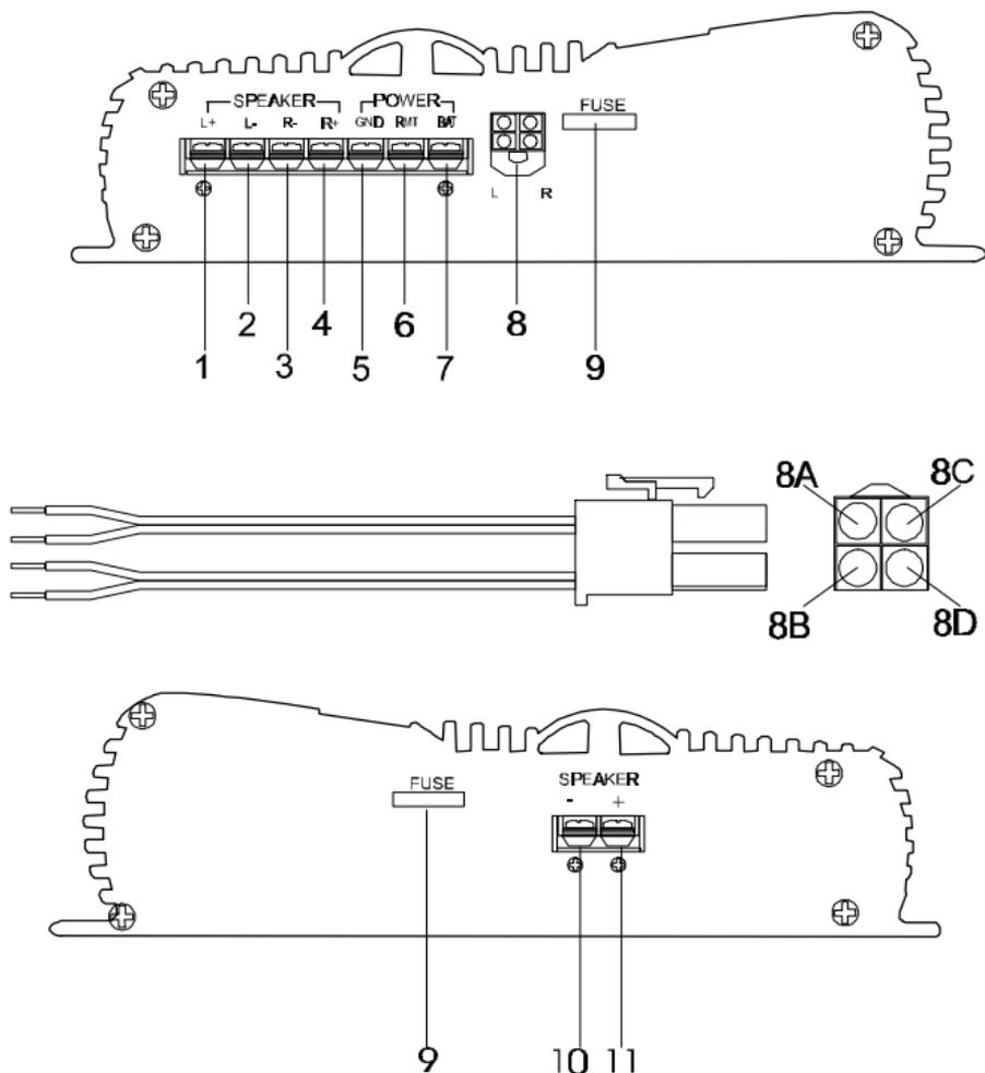
**Nunca coloque um aparelho em cima do outro** quando fizer a instalação, pois isto provocará o super aquecimento dos mesmos. Para evitar ruídos por efeitos “loop” de aterramento o amplificador deverá ser instalado em uma base isolante entre a carcaça do mesmo e o chassi do veículo.
