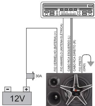
APLICAÇÃO DA CAIXA (CONEXÃO CONVENCIONAL) NÃO UTILIZAR ENTRADA RCA
