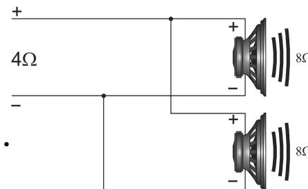
OBS.: Cálculo de Ligação em Paralelo - O inverso da soma dos inversos das impedâncias dos alto-falantes ligados em paralelo resulta a Impedância total do circuito.
