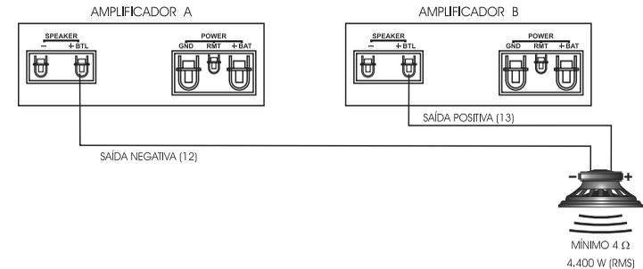
OBS: Impedância mínima de 4 Ohms em Bridge. A chave (8) do Amplificador (A) tem de estar na posição (180°) e do Amplificador (B) na posição (0°). O negativo de alimentação dos dois amplificadores têm de vir do mesmo ponto. O crossover também têm de estar na mesma posição nos dois aparelhos, assim como o controle de volume.
